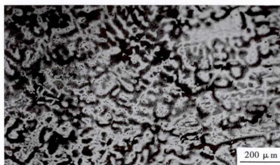
图5 Cr13Mn4Mo 钢电渣锭中枝晶形貌
